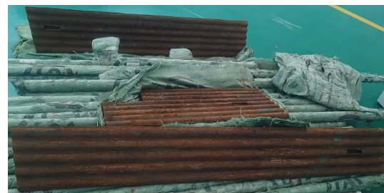
图 1 水冷壁管(服役失效)+焊接工况
