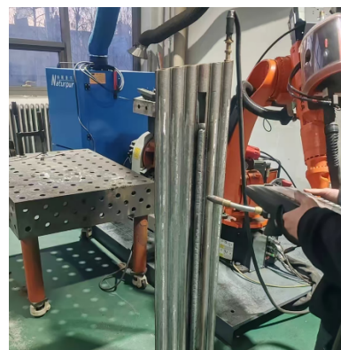
图5 除锈管及焊接工况
